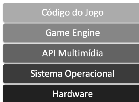
Figura 10: A Game Engine é uma nova camada de abstração Baseado em: Furtado (2012)
